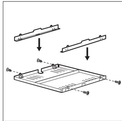
Jos käytössä on suojakotelo (lisävaruste), keittotason alapuolella oleva suojataso ei ole tarpeen. Suojakotelo ei välttämättä ole saatavilla kaikissa maissa lisävarusteena. Ota yhteys paikalliseen jälleenmyyjään.
