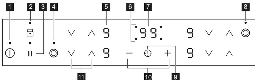
Folosiți câmpurile cu senzori pentru controlul aparatului. Afișajele, indicatoarele și semnalele sonore indică funcțiile active.
