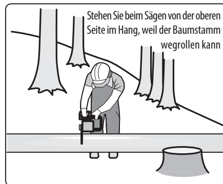
Querschneiden/-ablängen von Stämmen, Abb. 16
