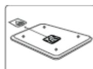
1. Înainte de utilizare, înlăturați folia din compartimentul pentru baterii de la baza aparatului. Pentru a înlătura bateriile, deschideți capacul compartimentului pentru baterii aflat la baza aparatului, apoi introduceți bateriile CR2032 (3V). Aveți grijă ca bateria să-o introduceți cu polul pozitiv în sus.
