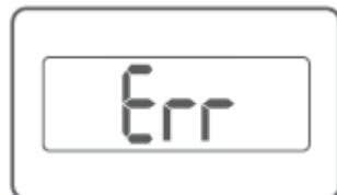
2. Ak začaženie presahuje merací rozsah váhy, na displeji sa objaví „Err“. Preťažením váhy sa môže poškodiť merací systém prístroja..
