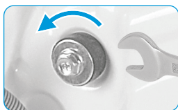
Ključem otpustite 4 transportna vijka
