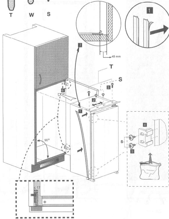
**Not:** 2-3 numara ile gösterilen montaj adiminda üst bağlantı plastiğini kaydırabilmek için bağlantının yapıldığı vidaları tam sıkmayınız.
