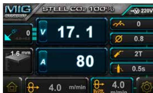
Utilizzare la manopola sinistra (1) per regolare finemente la tensione di saldatura. Avendo un controllo sinergico, questa correzione non influirà sulla velocità di avanzamento del filoscelta. Si consigli, prima di effettuare la correzione della tensione, di selezionare la velocità del filo desiderata facendo fede, in caso di necessità, alla tabella di saldatura a pag. 12.
