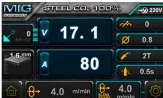
Funcția 2T/4T: apăsați butonul dreapta (4), comutatorul de selecție 2T/4T pentru a comuta între modurile 2T și 4T. Operarea 4T înseamnă că triggerul este tras o dată pentru a începe sudarea și tras din nou pentru a o opri. Acest lucru este util pentru îmbinări lungi de sudură. Modul 2T, triggerul trebuie să apăsați și menținut în timpul sudării.
