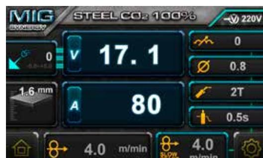
Apoi folosiți butonul stâng (1) pentru a regla tensiunea de sudare -5~+5V din setarea sinergică standard. Aceasta nu va schimba viteza firului. Se recomandă pentru o ușurință de utilizare ca mai întâi să fie reglată viteza țintă a alimentării cu fir și apoi să fie setată fin tensiunea, dacă este necesar. Consultați Diagrama de referință rapidă a Setărilor de sudare la pagina 21 și în interiorul usii alimentării cu fir pentru a găsi setări comune recomandate.
