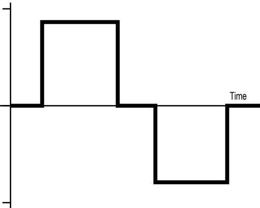
Modified Sine Wave / Módosított szinusz hullám / Modifikovaná sinusová vlna / Undă sinusoidală modificată / Modifikovaný sinusní signál / Modifikovaná sinusová vlna / Modificirani sinusni val
